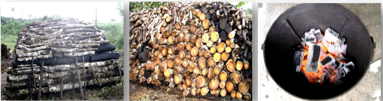
Figure 23: Illustration de quelques aspects de la carbonisation en meule traditionnelle
