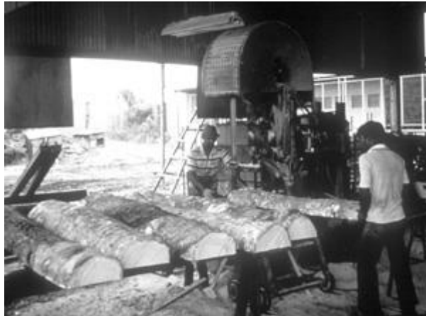
Figure 17: Sciage à plat du bois de Hevea brasiliensis par fendage de la grume en deux au premier passage
