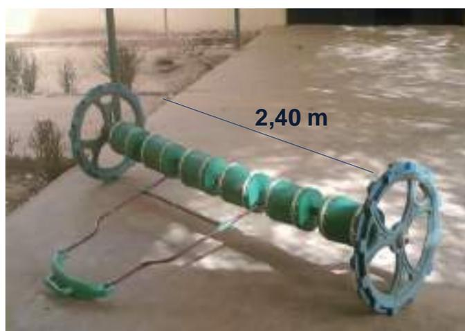
Figure 1 : prototype de semoir philippin
