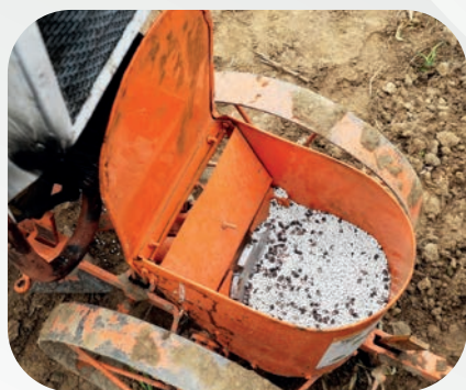
Mélange de la semence et de l'engrais mis dans le réservoir du SENEKELA
