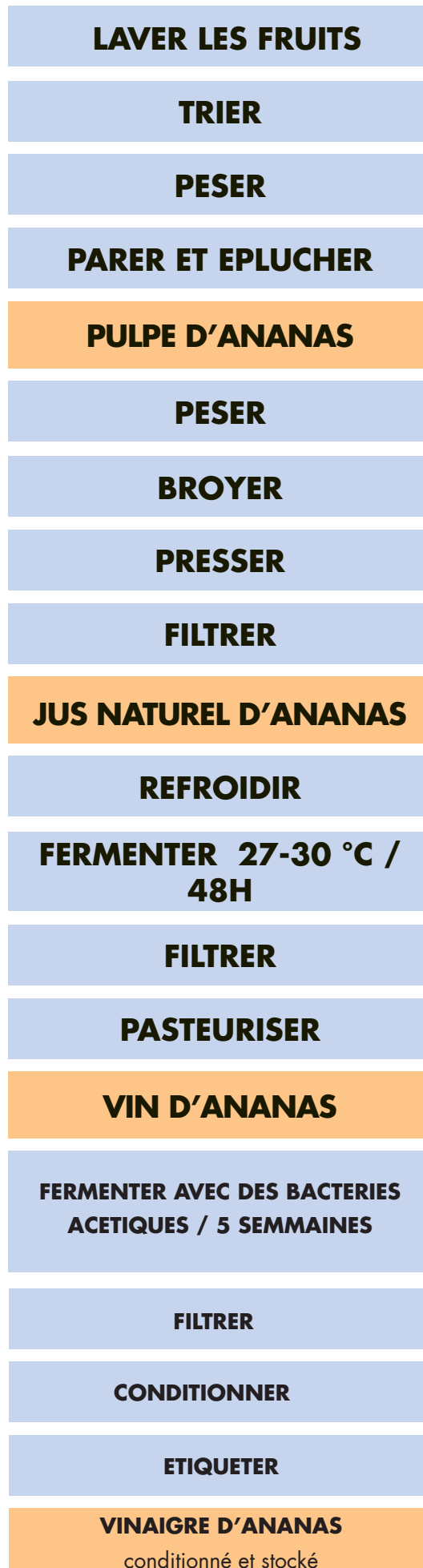
Figure 27 : Description des opérations séquentielles de production de vinaigre d'ananas
