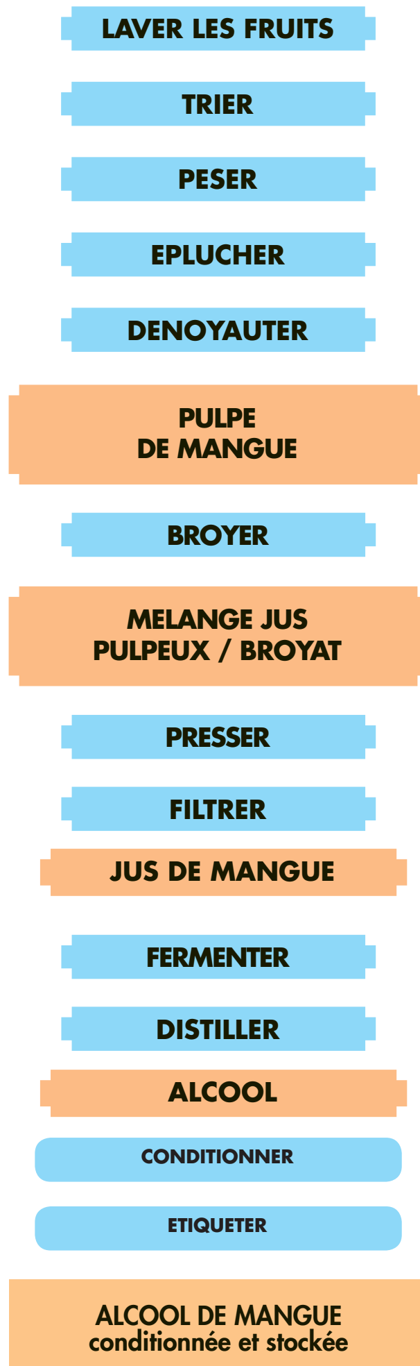
Figure 12: Description des opérations séquentielles de production d'alcool de mangue
