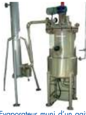
Evaporateur muni d'un agitateur (utilisé pour la fabrication des confitures)
