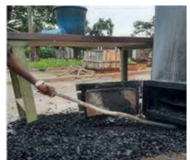
Fabrication du charbon à partir des coques à l'aide d'un pyrolyseur
