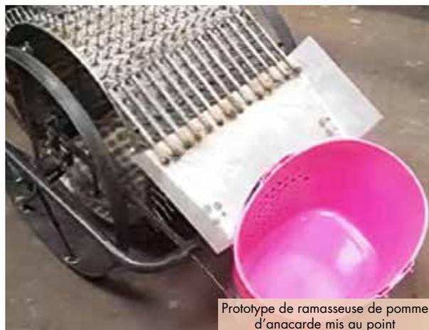
Prototype de ramasseuse de pomme d'anacarde mis au point
