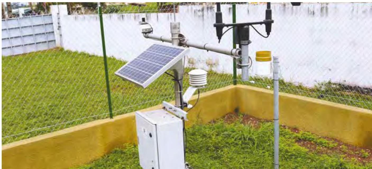
Modèle de station I-MOD-4 installé à la Préfecture de Tabou
